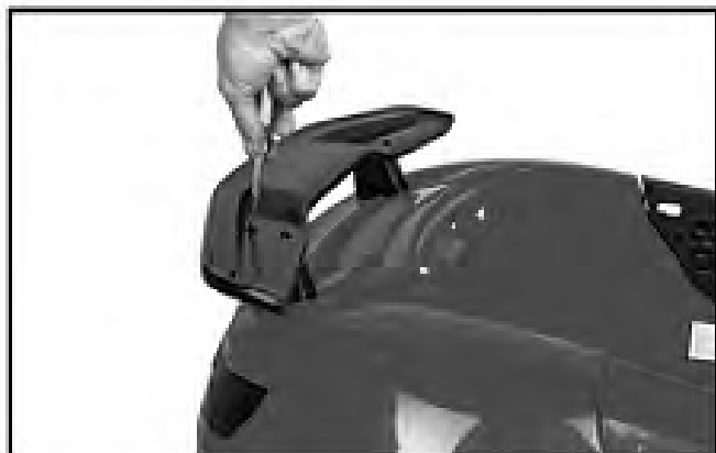
2. Montați deflectorul de aer cu ajutorul șuruburilor.
