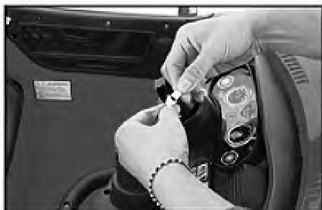
12. Conectați cablul volanului la cablul de alimentare.
