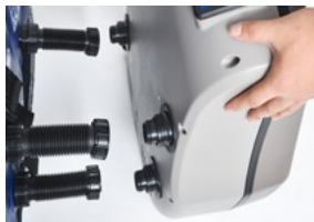
8) Csatlakoztassa a szivattyú egységet a medencéhez a 3 csavarható csatlakozó segítségével. Figyelje, hogy a szivattyú és a medence ikonjai egyezzenek.
