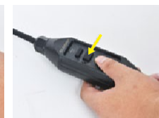
4. A «RESET» gombot újra megnyomva a jelzőfény pirosra vált. Az RCD működik.
