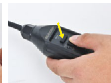
3. Nyomja meg a «TEST» gombot, a jelzőfény kikapcsol.
