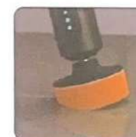
3. Lapos polírozókoronggal nyomja a csiszolóanyagot egy bizonyos dőlésszögben
