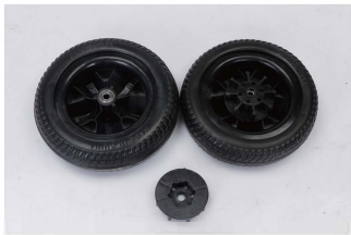
4. Csatlakoztassa a féktárcsákat mindkét hátsó kerékhez.
