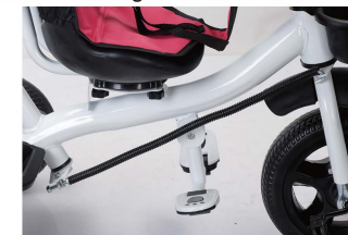
27. Kormányhuzal beépítése befejeződött
