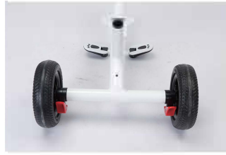
6. Der Einbau des Hinterrads ist abgeschlossen
