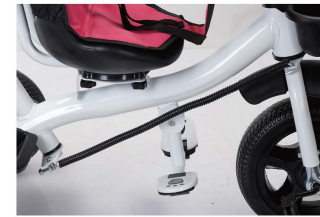
27. Efect de instalare cablu de direcție
