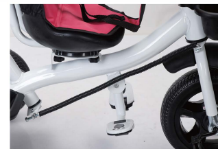
27. Efekt instalacji przewodu sterowego
