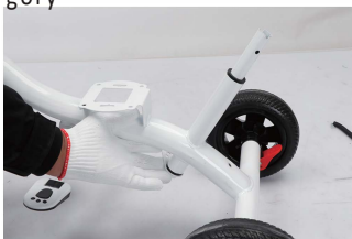
11. Przekłóć wał kierowniczy przez rurę kierowniczą
