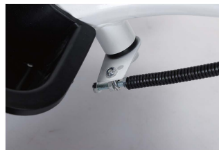
26. Tylony koniec linki sterowniczej jest zamocowany u dołu trójkąta rączki do pchania
