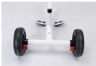
6. Montaż tylnego koła został ukończony
