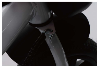
25. Przedni koniec linki sterowej zwiisa z trójkątą
