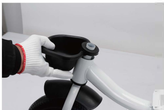
8. szerelje fel az első villát és szerelje fel a kosarat
