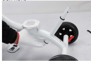
11. Führen Sie die Lenkwelle durch das Lenkrohr
