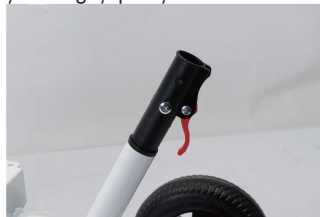
12. Instalați interfața de eliberare rapidă și așteptați ca bean-ul să iasă din el
