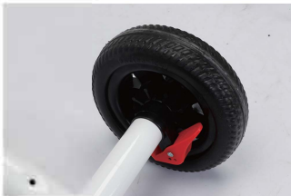
5. Szerelje be a hátsó kereket!
