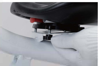
14. Szerelje be az ülést és igazítsa az ülés keret csavarfurataihoz, majd csavarja fel a csavart a rögzítéshez
