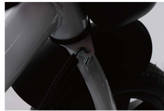
25. Capătul din față al sârmă de direcție atârână de triunghiul
