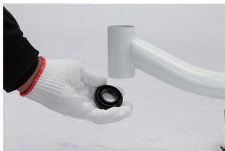
7. Zamontuj dolny koniec przedniej miski
