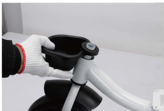
8. Zamontuj przedni widelec do góry
