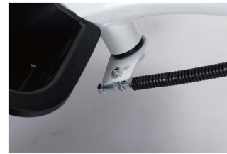
26. Capătul din spate al cablului de direcție este fixat în partea de jos a triunghiul mânerului de împingere
