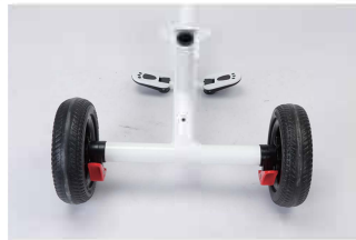
6. Instalarea roții din spate este completă
