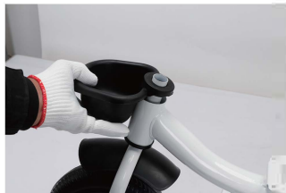
8. Instalați furca față în sus și montați coșul
