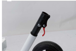
12. Installieren Sie die Schnellverschlusschnittstelle und warten Sie, bis die Bohne aus dem Loch herauspringt
