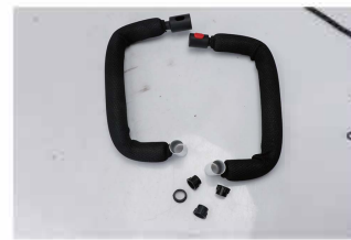
16. Geländer und Geländerpolster entfernen
