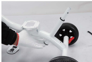
11. Treceți arborele de direcție prin tubul de direcție
