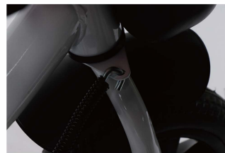
25. A kormányhuzal első vége a háromszögről lóg le.
