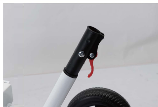
12. Nainštalujte rozhranie pre rýchle uvoľnenie počkajte, kým zmkov vyskočí z otvoru
