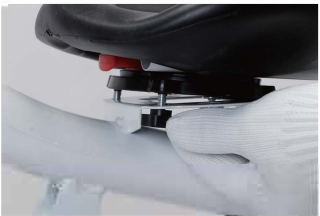
14. Installieren Sie den Sitz und richten Sie ihn an den Schraubenlöchern im Sitzrahmen aus. Schrauben Sie dann zur Befestigung die Senkschraube ein
