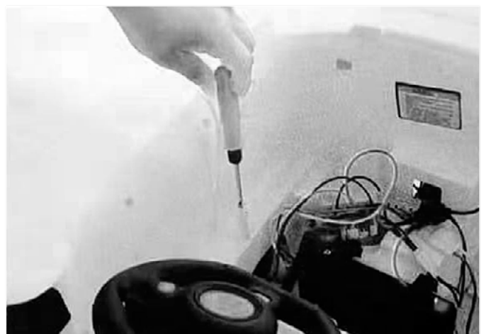
6. Sitzeinbau: Entfernen Sie die Karoserieschraube.
