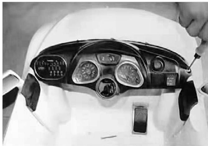
2. A műszerfal bal és jobb oldalán csavarokkal van rögzítve.
