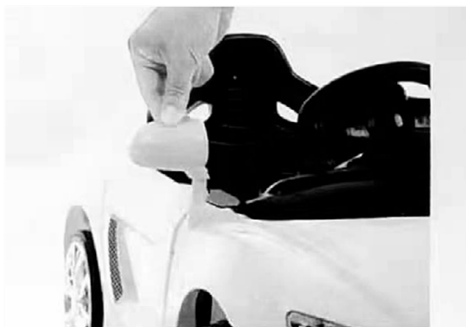
10. Zrkadlo nainštalujte do karosérie. Keď je na mieste, budete počuť zvuk „kliknutia“.
