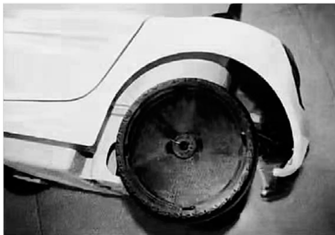
8. Scoateți zăvorul, apăsați roata și introduceți zăvorul.
