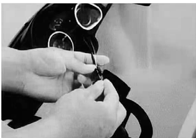
3. Konektor hudby: obr. Pred inštaláciou volantu pripojte vodiče.
