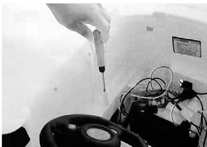
6. Montáž sedadla: odstráňte skrutku karosérie.
