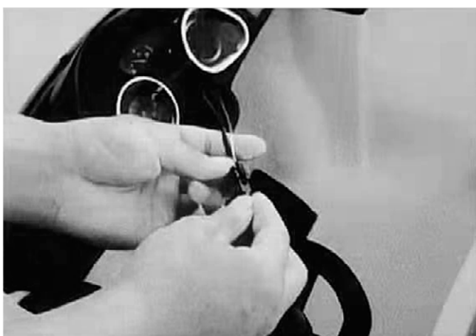
3. Conectorul pentru muzică: fig. Conectați firele înainte de a instala volanul.
