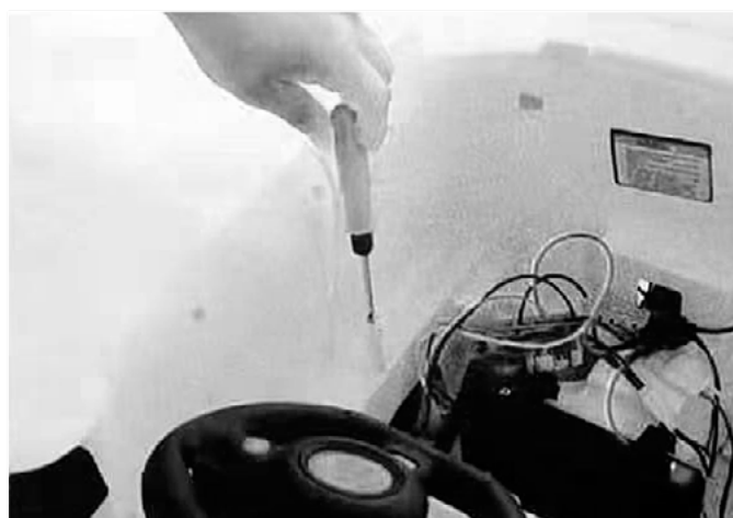
6. Instalarea scaunului: Îndepărtați șurubul corpului.
