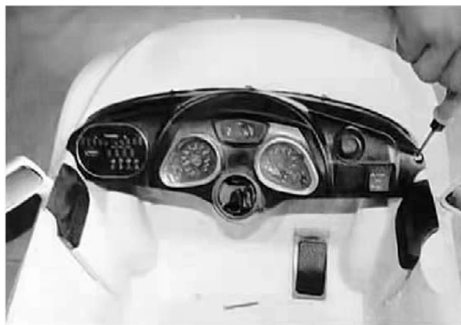
2. Tabloul de bord trece prin axul volanului și este fixat cu șuruburile din stânga și din dreapta.
