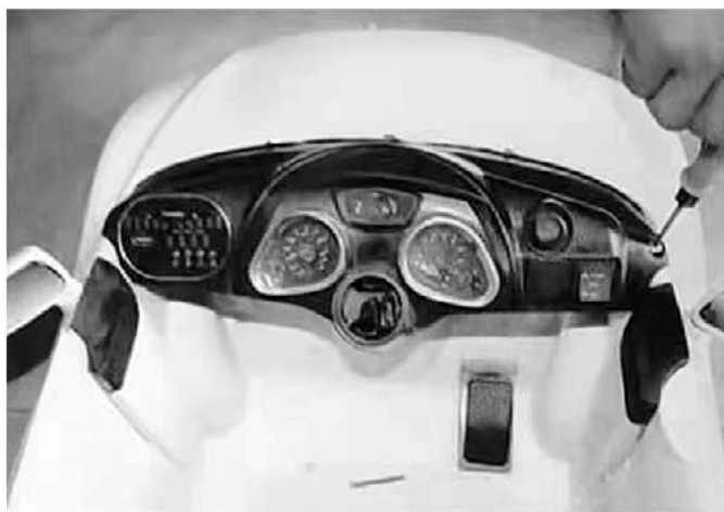
2. Prístrojová doska prechádza osou volantu a je zaistená ľavou a pravou skrutkou.
