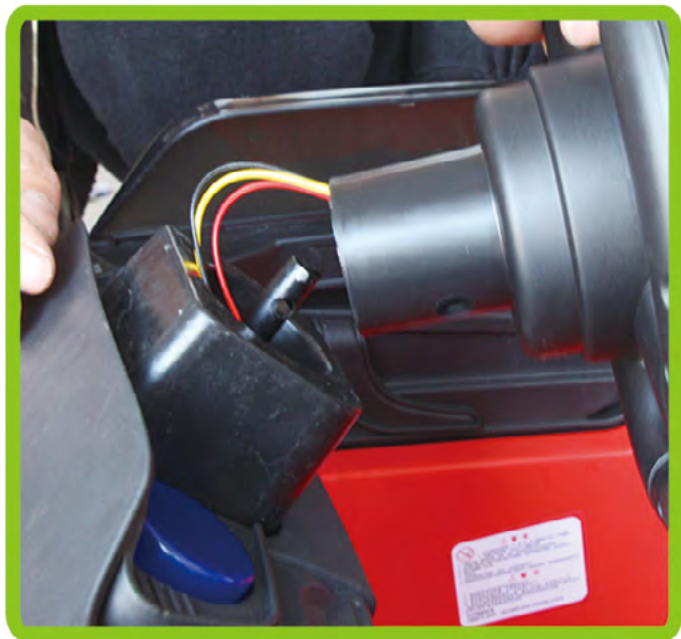
9. Helyezze a kormányt a helyére a tengelyre, vigyázzon a kábelekre!
