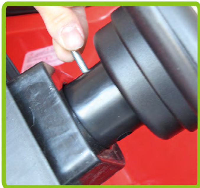
10. Vložte dlhú skrutku a utiahnite ju, aby ste upevnili riadidlá k.
