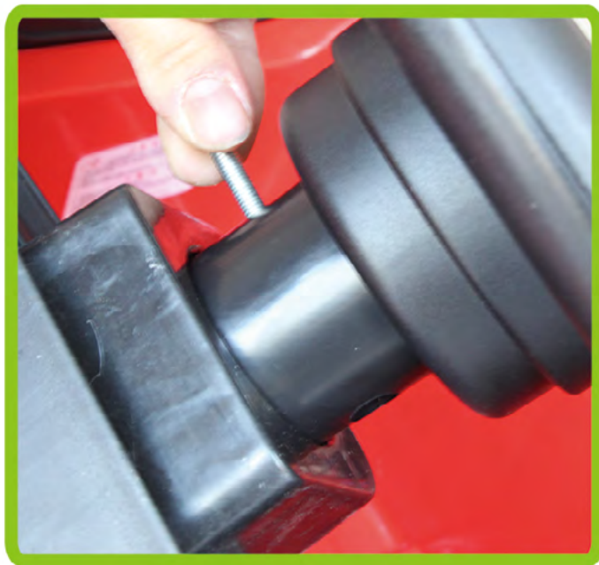
10. Helyezze be a hosszú csavart és szorítsa meg, hogy a kormány rögzüljön a tengelyhez.
