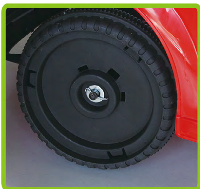
6. Puneți o șaibă pe axă și apoi împingeți știftul de vultur prin axă prin orificiul din axă, apoi îndoiți ușor capătul știftului cu zăvorâre.
