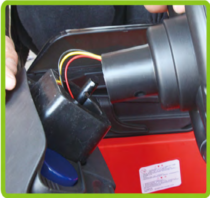
9. Setzen Sie den Lenker auf die Achse und achten Sie auf die Kabel!
