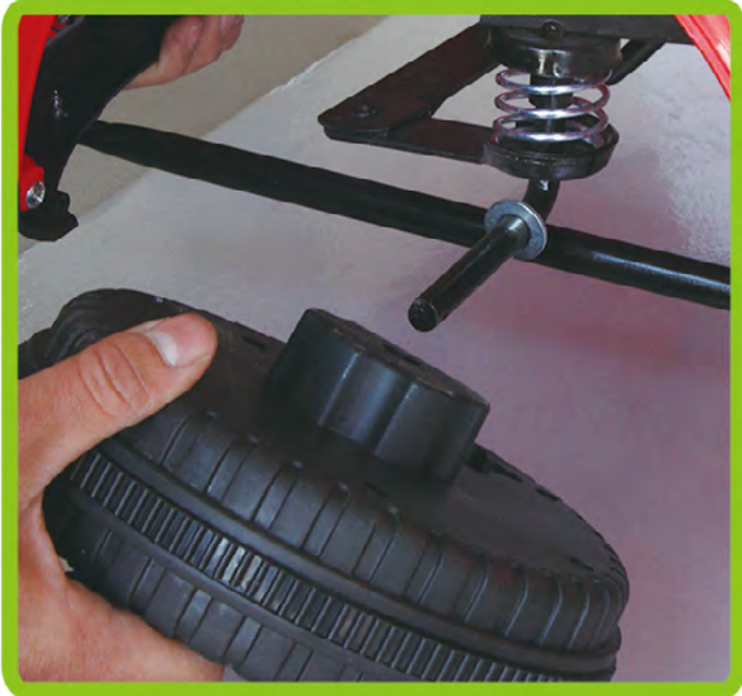
5. Das Vorderrad mit der Hinterachse verbinden .
