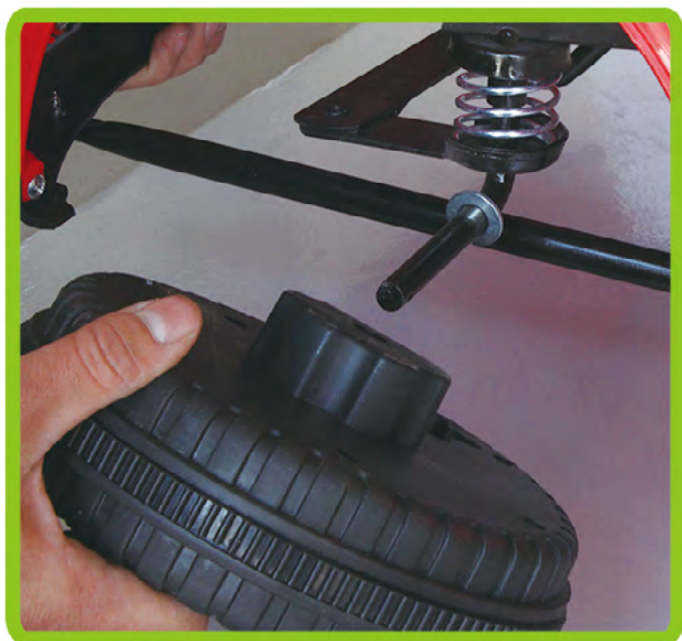
5. Ansamblul roții din față, conectați roata la axa spate.
