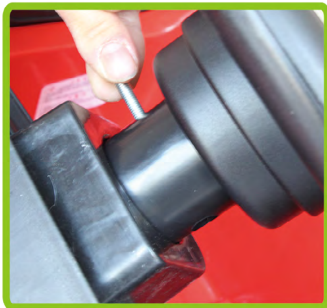
10. Introduceți șurubul lung și strângeți-l pentru a fixa ghidonul de ghidon pe.
